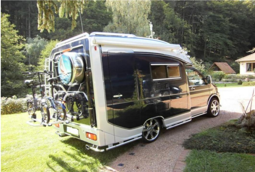
Rolfs, DK4XI aktuelles WOMO, rechts hinten KW Motorantenne, vorn Scheiben UKW Antenne
