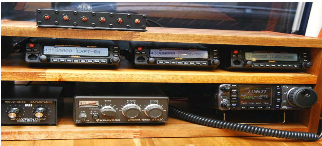
Links oben: 70cm Relais mit Weiche, rechts oben Crossband 2m/70cm. Unten KW-TRX mit Tuner. Dazu kommt noch ein APRS TRX TM-D 710 GE
