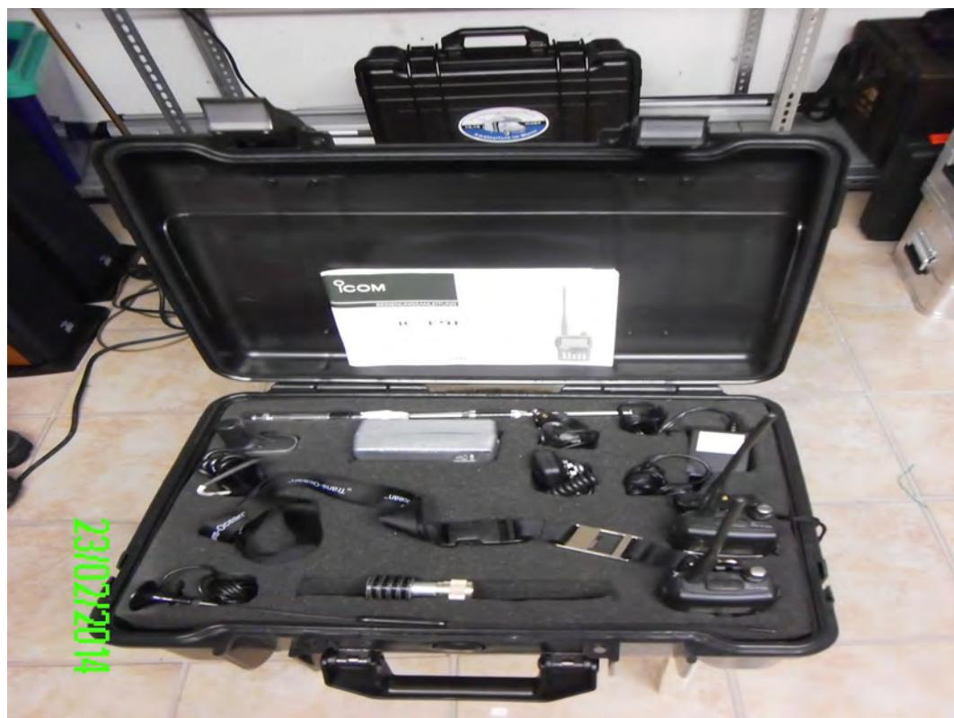
Mindestens ein Handfunkgerät 2m/70cm mit Zubehör, wie Ladegerät 12V/220V, 2. Akku Handmikro/Lautsprecher, Ohrhörer, usw in einem stabilen Koffer.
